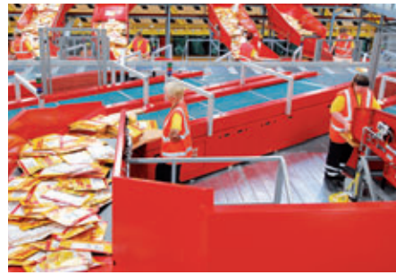
Die vollautomatischen Anlagen können in der Stunde rund 100 000 Päckchen, Großbriefe und nicht bandfähige Sendungen sortieren
